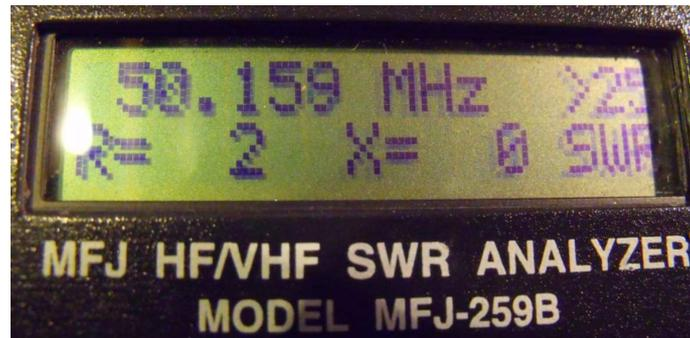
Il suffit ensuite de démonter la PL259 et dénuder l'âme au raz de la masse, puis rabattre l'âme sur la masse et faire une soudure (attention l'échauffement de l'âme et le raccourcissement de l'isolant fait augmenter la fréquence de résonance).
