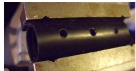
Puis agrandir les trous à 10 ou 11 mm et enfin scier le tube plastique sur l'axe des trous ; Nous obtenons ceci :
