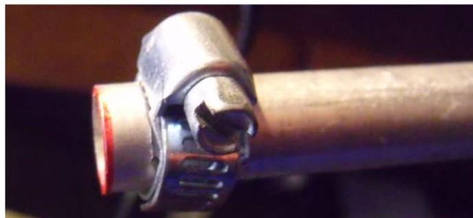
Les tubes de 11 mm de 1 m, sont introduits dans les extrémités du tube central de façon à augmenter la longueur du brin rayonnant.
