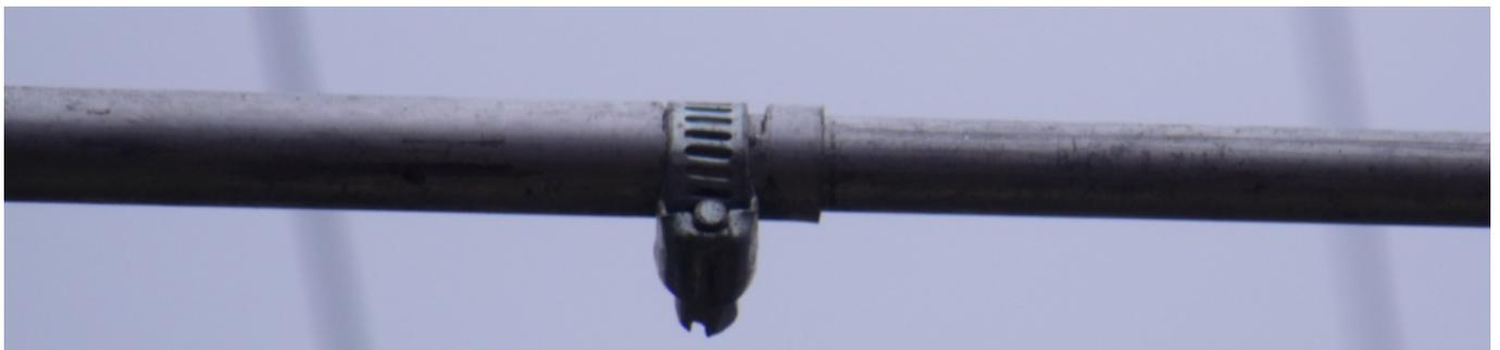
Pour régler l'insertion glisser le tube jusqu'à ce que la côte du milieu à l'extrémité de chaque brin, soit de 1 435 mm (La longueur totale, du brin rayonnant étant de 2 870 mm)
